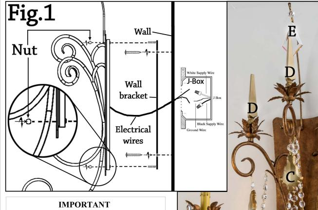
TURN OFF THE POWER AT THE MAIN FUSE OR CIRCUIT BREAKER BOX BEFORE STARTING INSTALLATION
